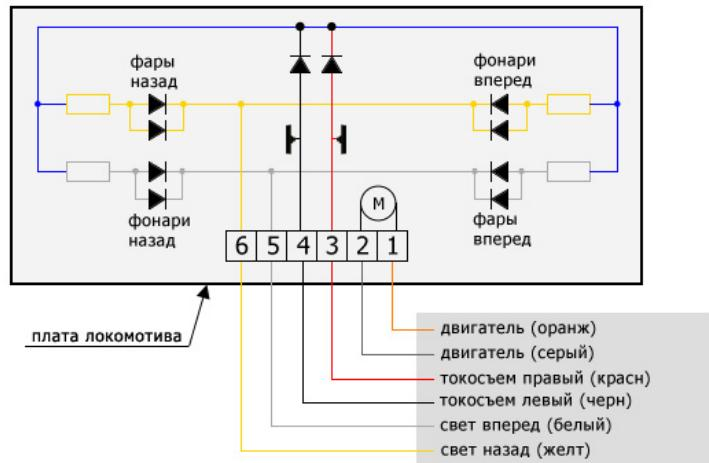
Если в локомотиве нет разъема соедините провода пайкой в соответствии со схемой:
