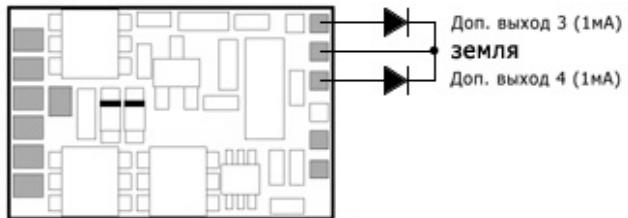
**Важно !** – не подключайте эти выходы с использованием синего провода (+20В) - декодер может выйти из строя.
